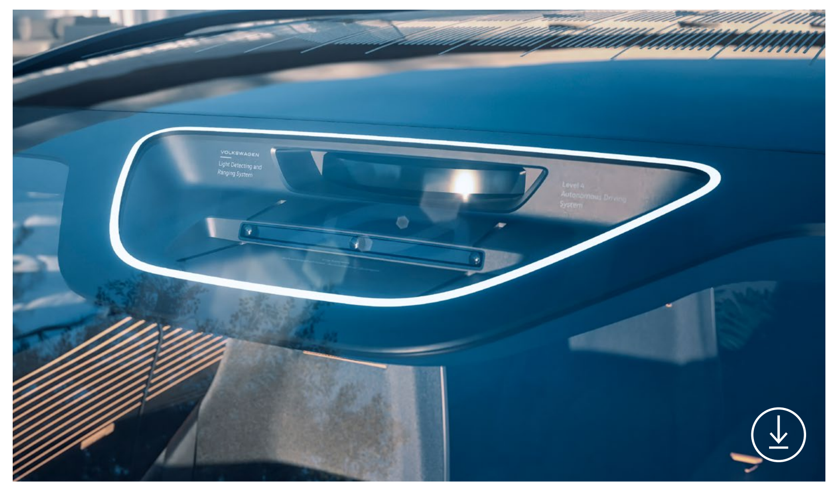
Im oberen Bereich der Frontpartie befindet sich ein Lidar- und Kamera-Sensor: der „Centre Pilot“
