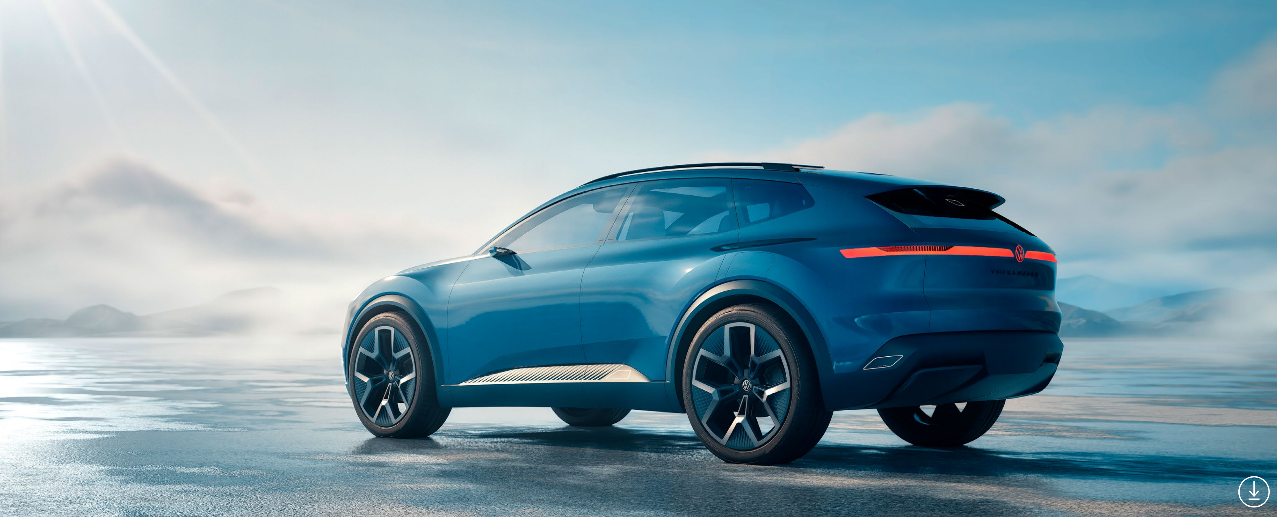
Komplett in das Design integriert wurde die Level-4-Sensorik. Klassische Außenspiegel werden durch Außenkameras ersetzt
