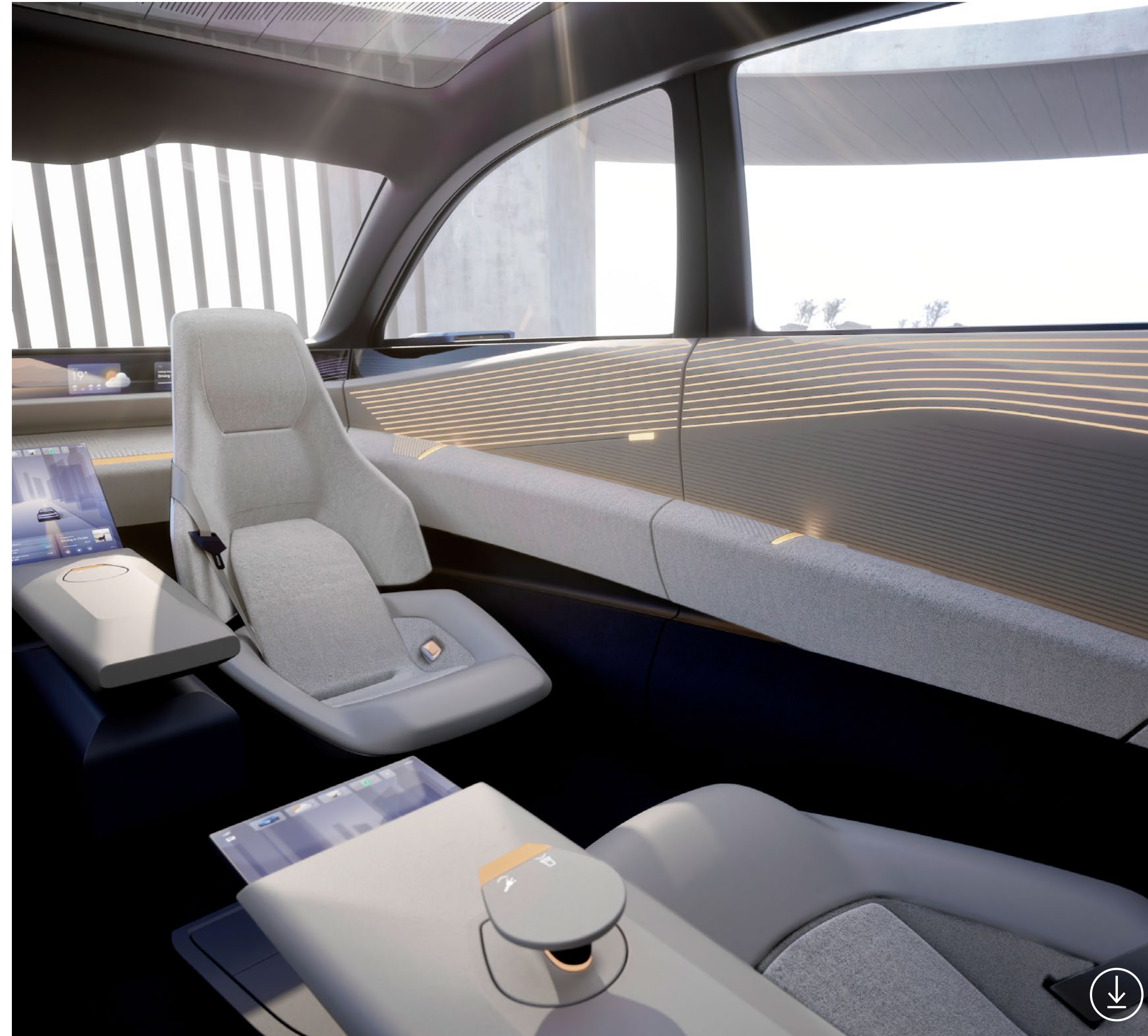
Im autonomen Fahrmodus können die vorderen Sitze um 180 Grad gedreht werden – Front- und Fondpassagiere sitzen sich gegenüber
