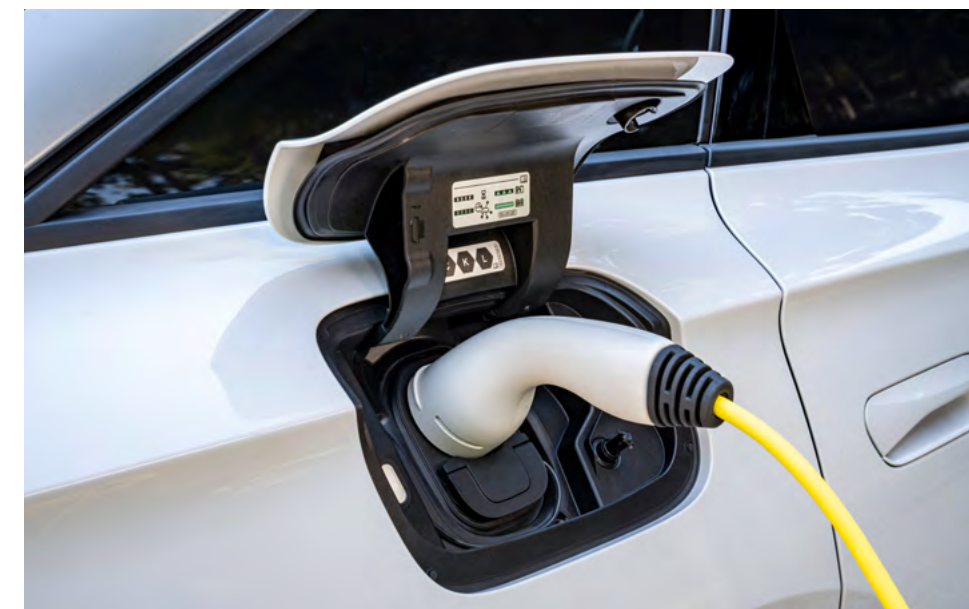
Die Ladeklappe schwenkt nach oben; die Steckdose ist so stets optimal erreichbar.
