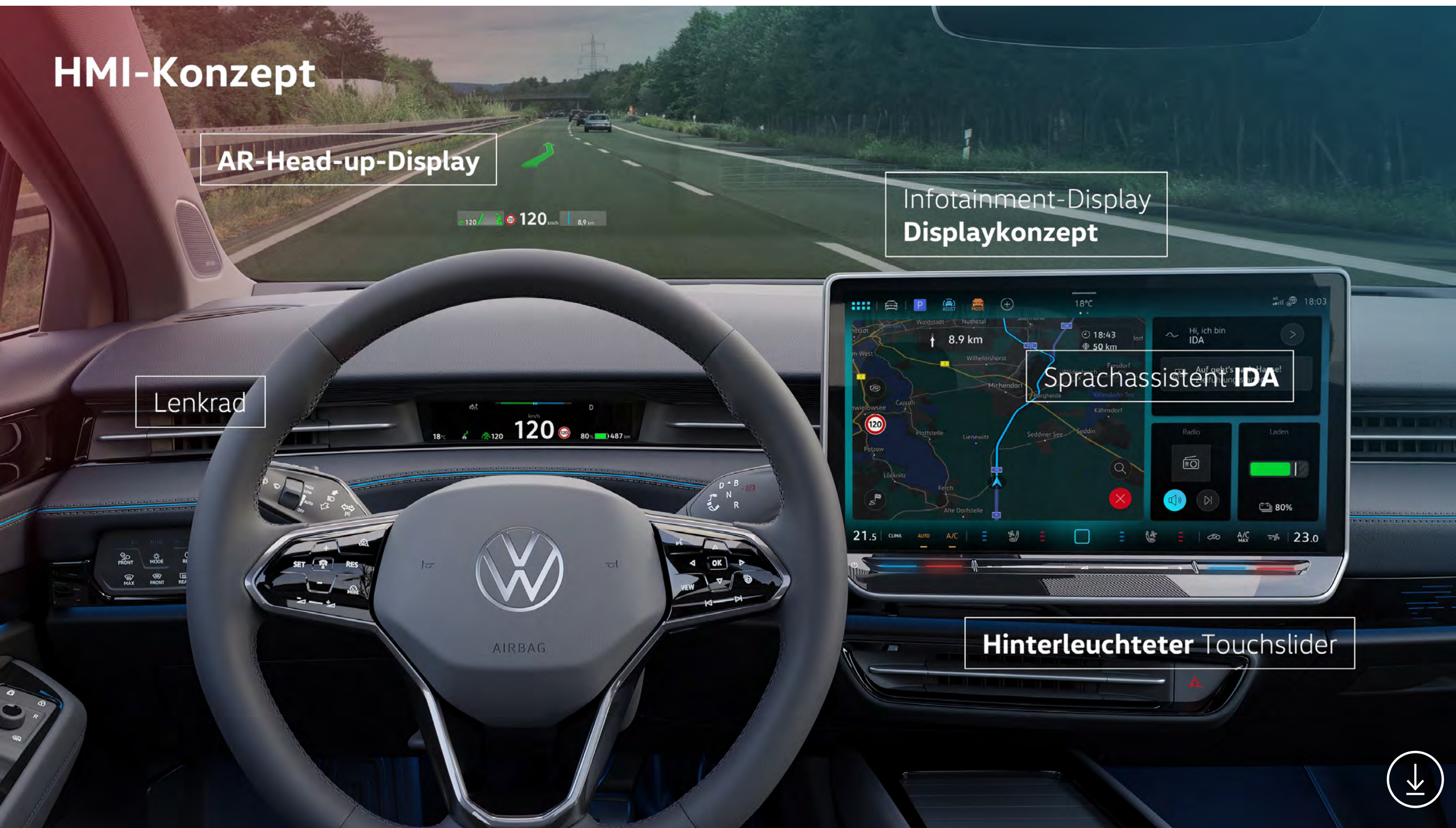
Blick auf das AR-Head-up-Display aus der Perspektive des Fahrers
