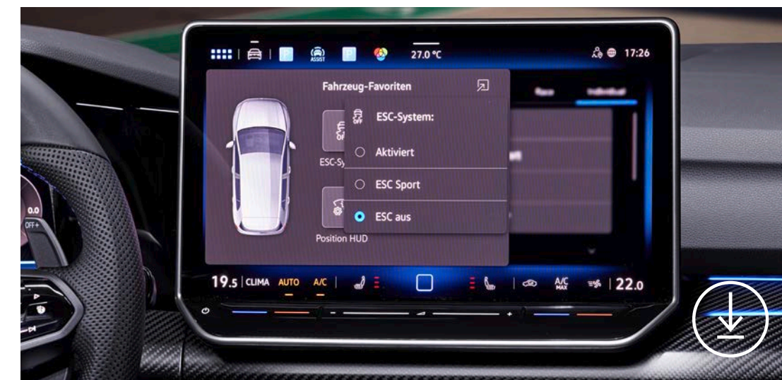
Der Fahrer kann das ESC an den jeweiligen Einsatz anpassen.
