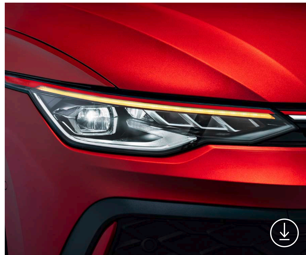
Die neueste Generation der „IQ.LIGHT – Matrix-Scheinwerfer“ 4 und die ebenfalls neuen 3D-LED-Rückleuchten 4 mit dynamischer Blinkfunktion
