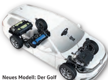
Neues Modell: Der Golf Variant TGI verfügt über drei Erdgastanks.
