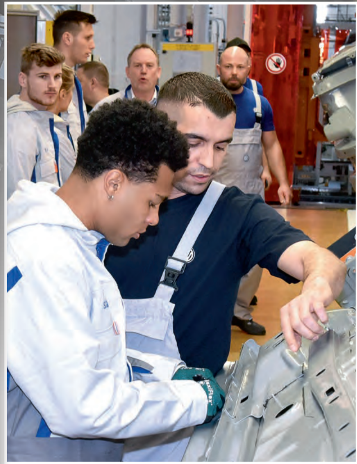
Tatkräftige Unterstützung: Teamsprecher Mirsad Bili (rechts) zeigt Serge Gnabry, wie der Stopfen in den Unterboden gesetzt wird.
