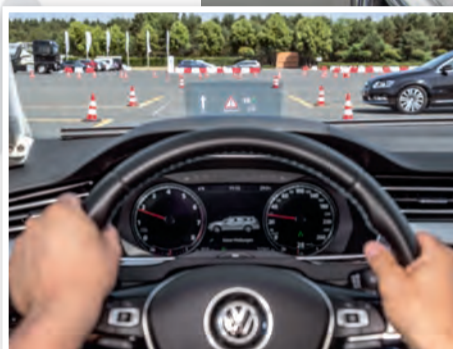
Der „Schutzengel“ passt auf: Wenn es brenzlich wird, kann das System reagieren und den Fahrer zum Beispiel zum Bremsen auffordern.
