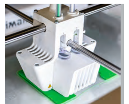
3D-Drucker im Einsatz: Flüssiger Kunststoff wird Schicht für Schicht zu einem Bauteil zusammengefügt und härtet aus.
