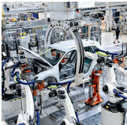
Im Montagefluss: Die „Torque Station“ verschraubt im Schnitt 25 Punkte am Tiguan, Touran oder Tarraco.
