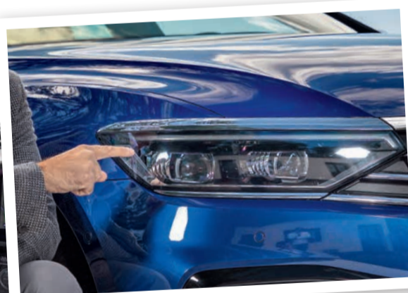
Optional: LED-Matrix-Scheinwerfer im neuen Passat.
