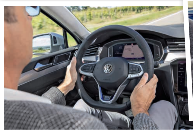
Kapazitives Lenkrad: prüft Fahrtüchtigkeit durch Berühren.
