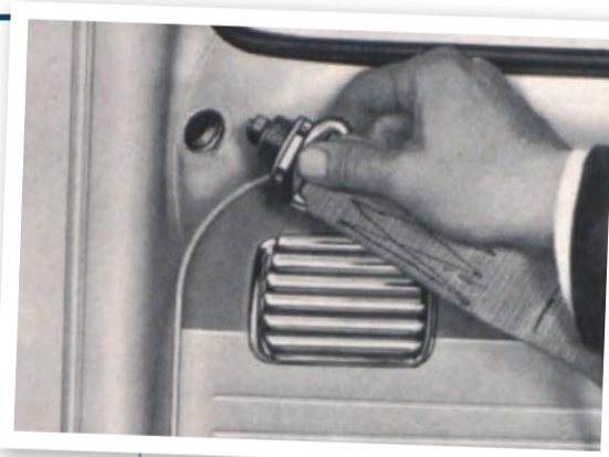
Damals bahnbrechend: Gurtbefestigungspunkte im Käfer.
