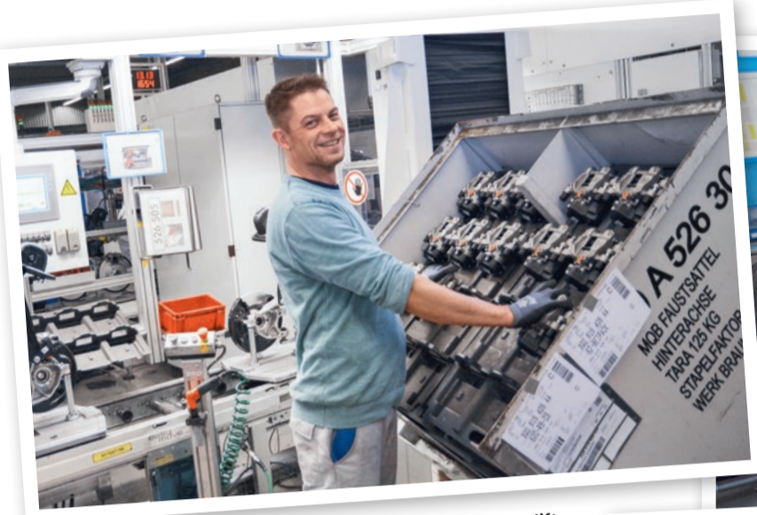
Macht die Arbeit leichter: Heiko Funk freut sich über die Edmolifte, die die Faustsattel-Behälter optimal anheben und neigen.
