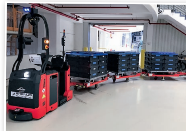
Fahrerloses Transportsystem: transportiert Material völlig autonom.
