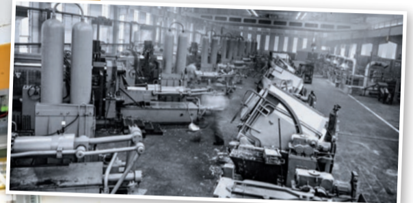
1961: Die 800-Tonnen-Druckgussmaschinen stehen in Reih und Glied mit Warmhalteöfen zur manuellen Beschickung der Maschinen.
