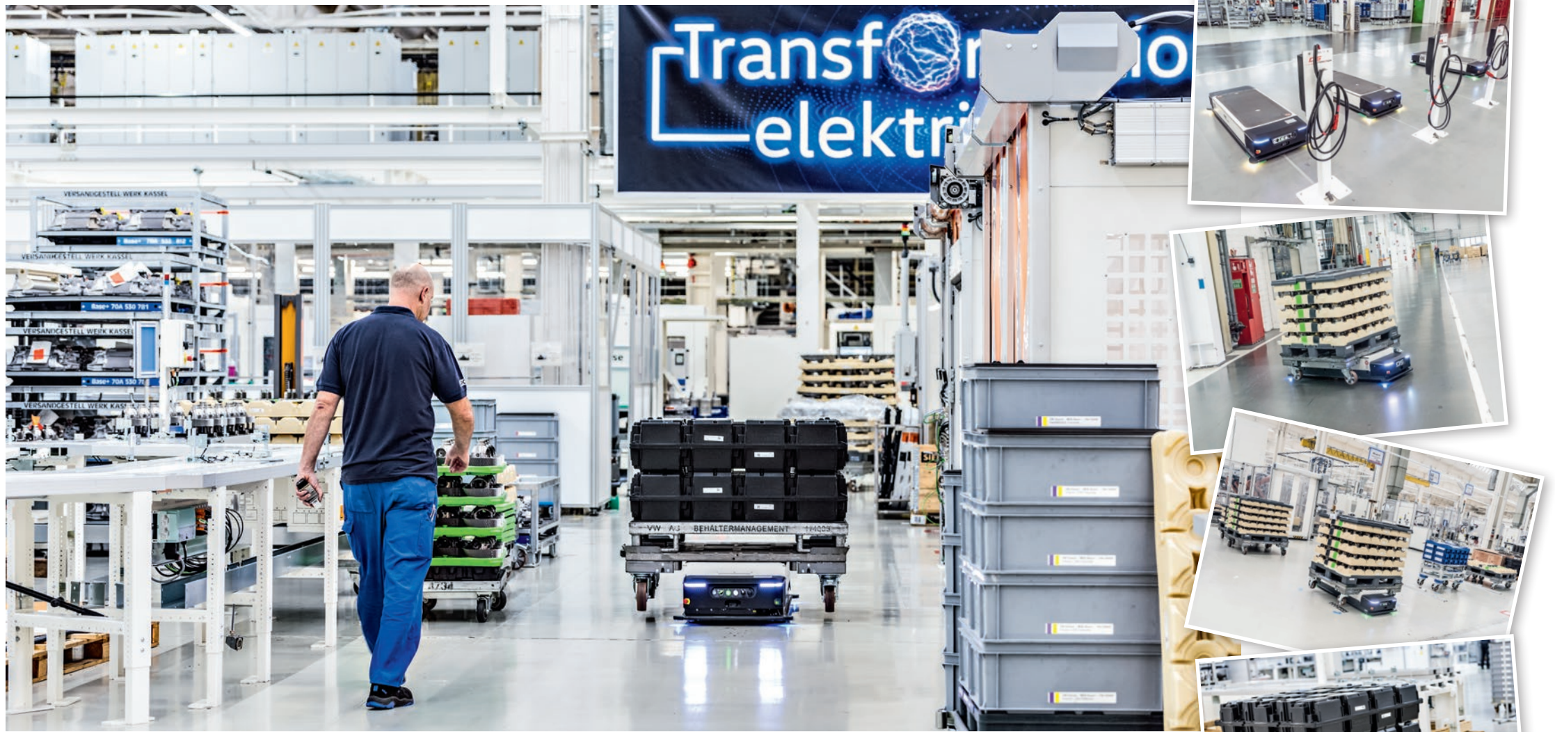
Wie ein Saugroboter im Haushalt orientiert sich das FTF in der Halle 1: Es erkennt seine Umgebung und fährt die eingespeicherte Route präzise mit einer Last von bis zu einer Tonne ab.
