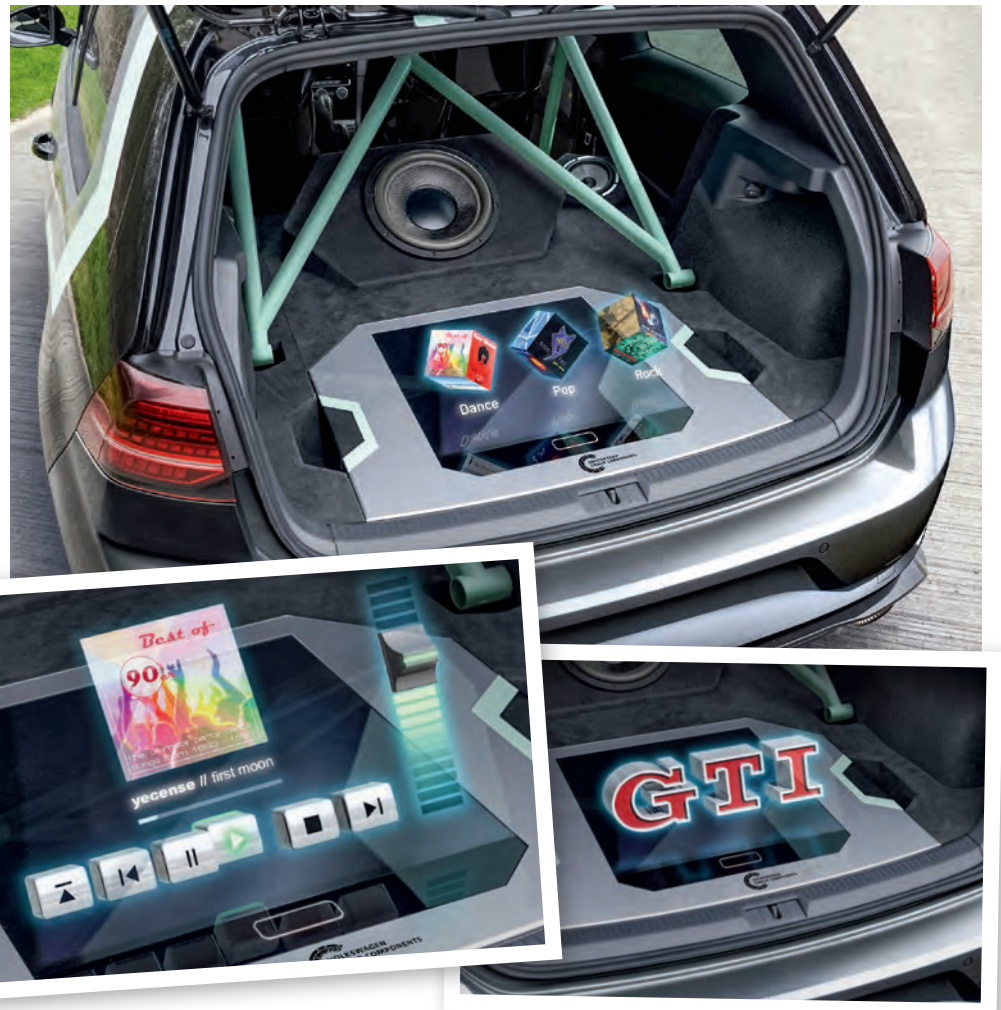
Frei schwebende Bedienelemente, über die das Soundsystem gesteuert wird: Im Kofferraum der Studie wurde das von der Komponente entwickelte Hologramm-Modul verbaut.
