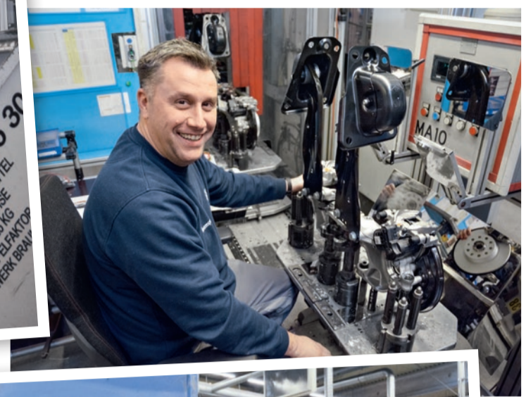
Bessere Kontrolle durch Spiegel: Teamsprecher Michael Kupinski am ZP-2-Arbeitsplatz des Radtriebs, der durch neue Spiegel eine bessere Qualitätskontrolle bei gleichzeitiger Arbeitserleichterung ermöglicht.
