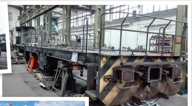
Vierachsige Altlokomotive: Sie wird bis auf den Rahmen abgebaut und ab dem Fahrwerk aufwärts komplett mit neuen Komponenten aufgebaut.
