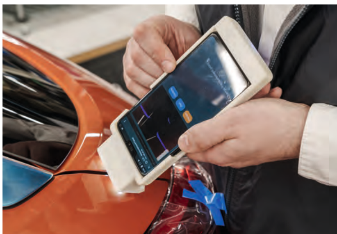
Neues Werkzeug: Mit dem Messgerät werden automatisch und digital Abstände und Einschlüsse auf allen Glasarten gemessen.
