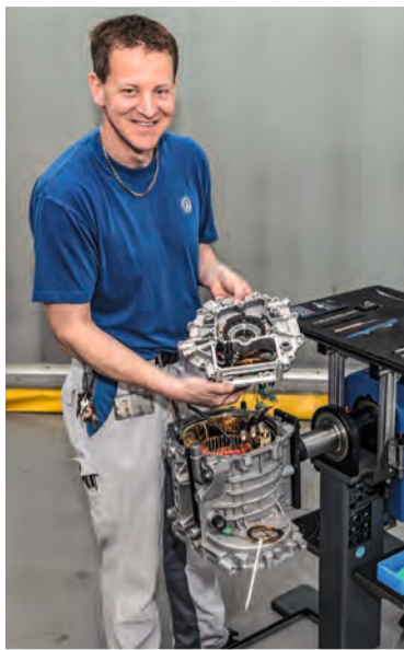
Moderne Technik: Tino Herwig statet den Prototyp eines Base-Elektroantriebs mit zusätzlichen Messsensoren aus.
