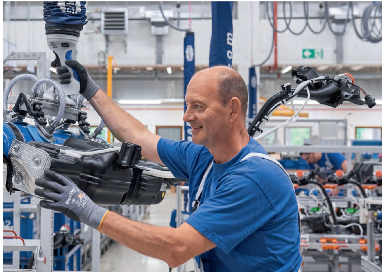
Blick in die Gasrackfertigung: Moderne Handlinggeräte erleichtern Steffen Gerth und seinen Kollegen die Durchführung der einzelnen Montageschritte.
