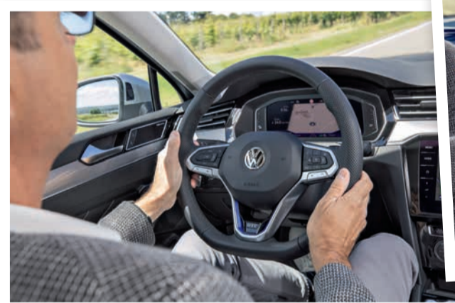
Kapazitives Lenkrad: prüft Fahrtüchtigkeit durch Berühren.
