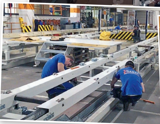
In der Lackiererei: Die Fördertechnik wurde umgebaut.
