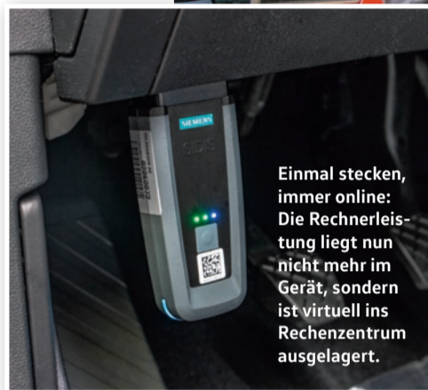
Ohne dieses Gerät kann kein Fahrzeug in Betrieb genommen werden: Frederik Kluwe erläutert die neue Schnittstelle, die als Dolmetscher zwischen dem Prüfprogramm und dem Auto fungiert.
