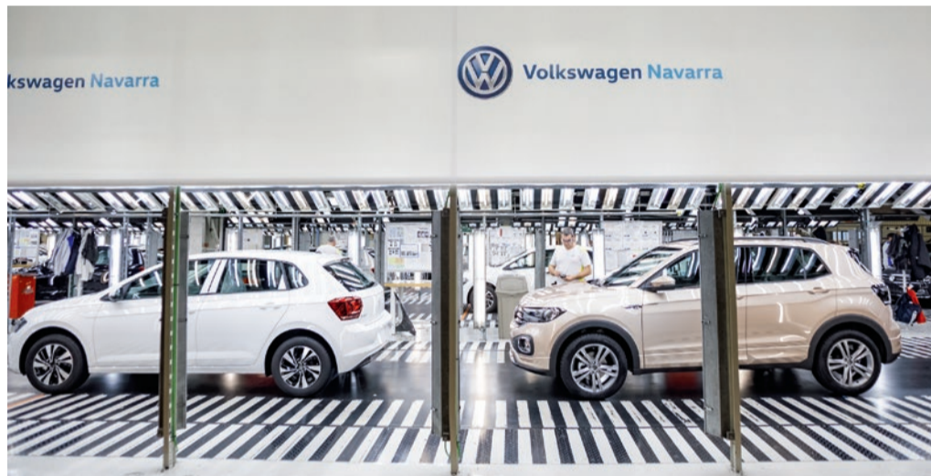
Erfolgsbeispiel im Werk Pamplona: Durch die Reduzierung von Bauteilen ist es möglich, Polo und T-Cross auf den gleichen Bändern laufen zu lassen.
