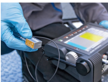
Vor der Prüfung steht die Wahl des Prüfkopfs an – je nachdem, welchen Werkstoff Daniel Piper „durchleuchtet“.
