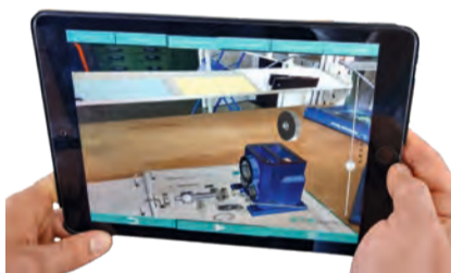
Mit Augmented Reality: Einbauanweisung beim Getriebelehrgang.
