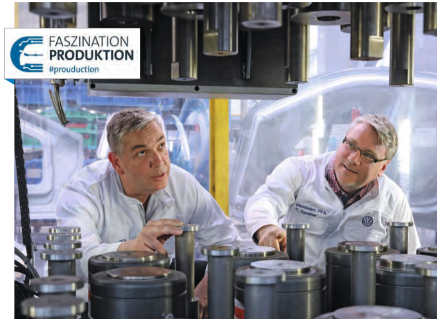
Alles in Ordnung: Die Maschinenschlosser Volker Matzner (links) und Tino Sandner kontrollieren die Sensoren des Pressenfingerabdruck-Werkzeugs zu Beginn der Messung.
