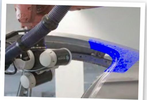
Messarm der Doppelarm-Roboterzelle: Belichtungszeit etwa 3 Millisekunden pro Bild (blaues Licht).
