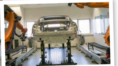
Doppelarm-Roboterzelle mit zu messendem Bauteil: Messzeit etwa 20 Minuten.
