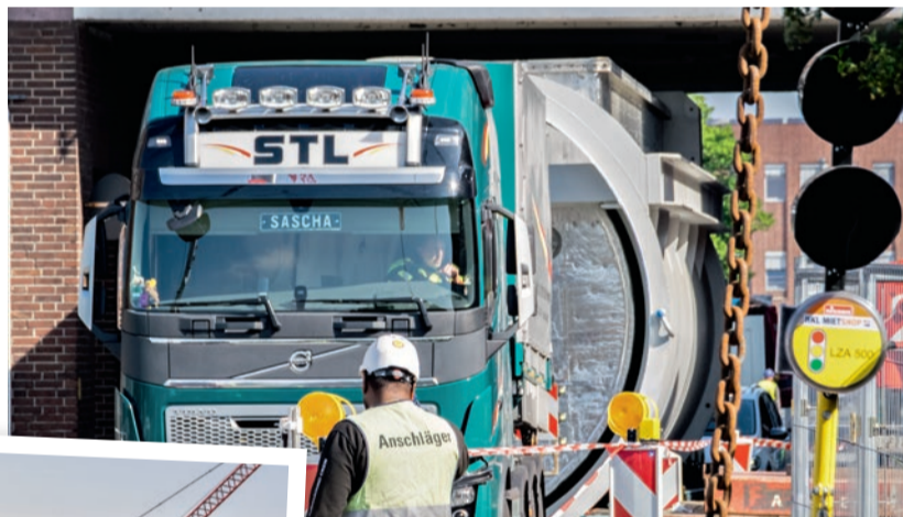
Gerade noch Platz: Das Kaminteil fährt auf einem Schwerlasttransporter durch den Überbau auf Straße 5.
