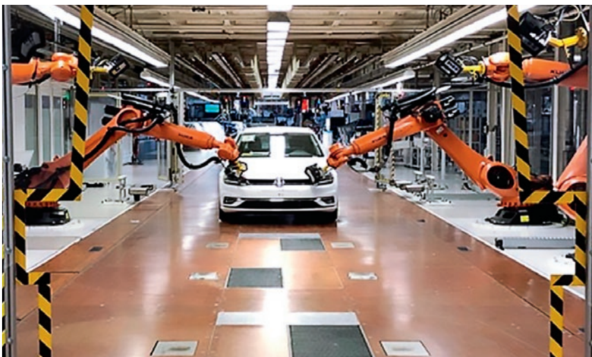
Neuer Bandabschnitt auf der Montagelinie 3: Das automatisierte und robotergesteuerte Scannen von Spaltmaßen.
