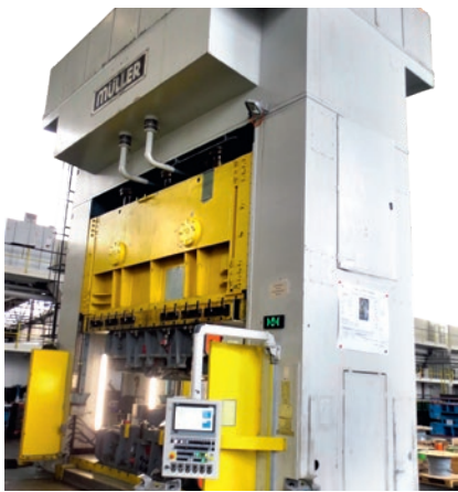
Im Presswerkzeugbau: die modernisierte Ziehpresse.
