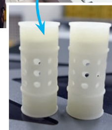
Runde Sache: Azubi Daniel Schmidt hat neue Rollen für die Sortiermaschine der Poststelle gefertigt.
