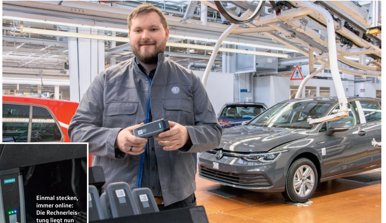
Ohne dieses Gerät kann kein Fahrzeug in Betrieb genommen werden: Frederik Kluwe erläutert die neue Schnittstelle, die als Dolmetscher zwischen dem Prüfprogramm und dem Auto fungiert.
