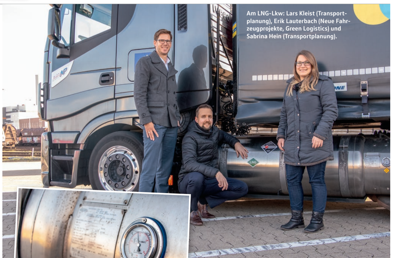
Temperaturmesser am Tank: Nur von -161 Grad bis -164 Grad ist das Erdgas flüssig.
