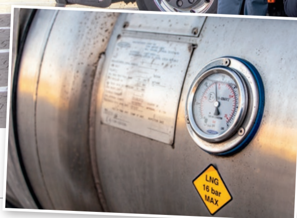
Temperaturmesser am Tank: Nur von -161 Grad bis -164 Grad ist das Erdgas flüssig.
