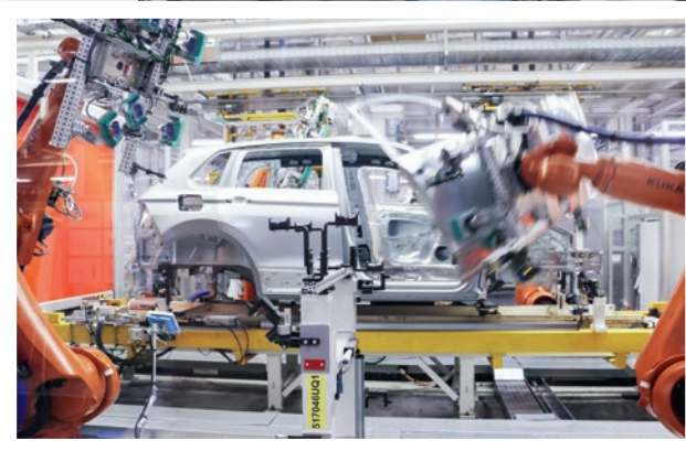
Nach dem Umbau: Der automatisierte Türereinbau im Karosseriebau der Fertigung 2.
