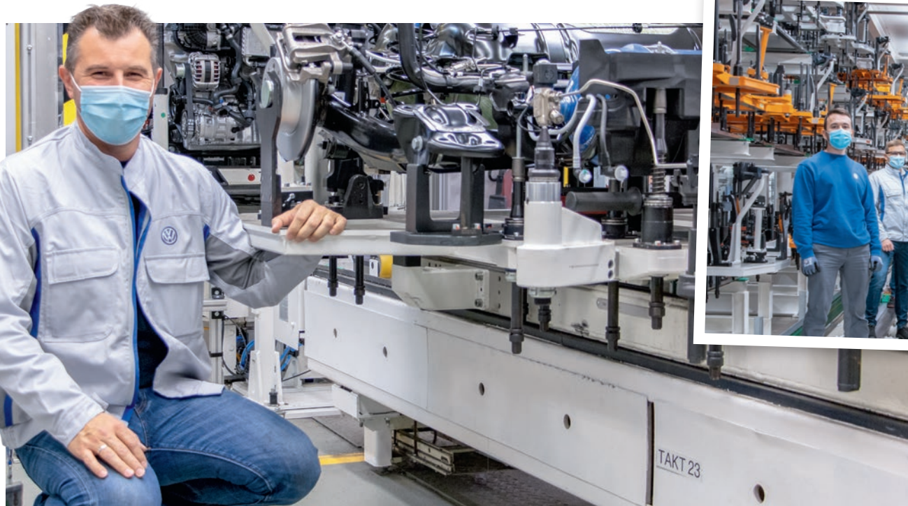
Die Hochzeit steht kurz bevor: Planer Lars Krol am Fahrwerk, das auf den Modulträgern aufgebaut wurde. Seine Hand liegt auf dem Stahlrahmen.
