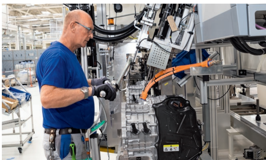
Effiziente Lücke für nachträgliche Automatisierung: Noch müssen Markus Bier und seine Kollegen die Getriebegehäuse per Hand auf das Montageband legen. Doch die Planung hat hier frühzeitig genug Fläche für eine Automatisierung eingeplant.
