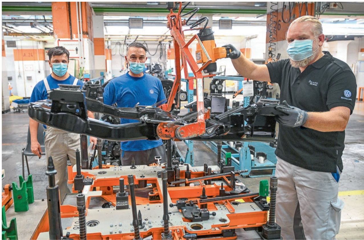
In der Produktion: Werkleiter Hahlbohm (rechts) legt den Montageschemel auf das FTF – unter Aufsicht von Recayi Demirci (Mitte) und Teamsprecher Anastasios Zoumpoulis.
