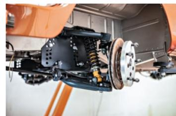
**Neues Fahrgefühl:** Der e-BULLI bekommt ein neu konzipiertes Fahrwerk: Mehrlenker-Vorder- und -Hinterachsen mit verstellbaren Stoßdämpfern und Gewindefederbeinen sowie eine neue Zahnstangenlenkung und vier innenbelüftete Scheibenbremsen. Das heißt: mehr Komfort, mehr Dynamik, mehr Sicherheit.
