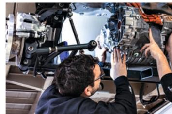
motor mit 61 kW (83 PS) für lautlose Power. Maximales Drehmoment: 212 Nm – das ist mehr als die zweifache Kraft des ursprünglichen T1-Motors von 1966.
