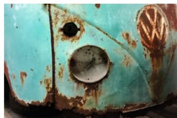
**Die Basis:** Ein 1966 in Hannover produzierter T1 Samba-Bus, der zuvor 50 Jahre in Kalifornien unterwegs und in keinem besonders guten Zustand war. Der Bus musste komplett neu aufgebaut werden, um ihn später mit den neuesten Elektro-Komponenten von Volkswagen bestücken zu können.
