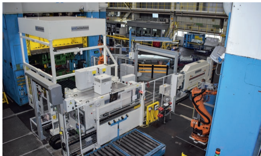
Seit Jahresbeginn in Betrieb: Anlagen zur materialabhängigen Blechreinigung.
