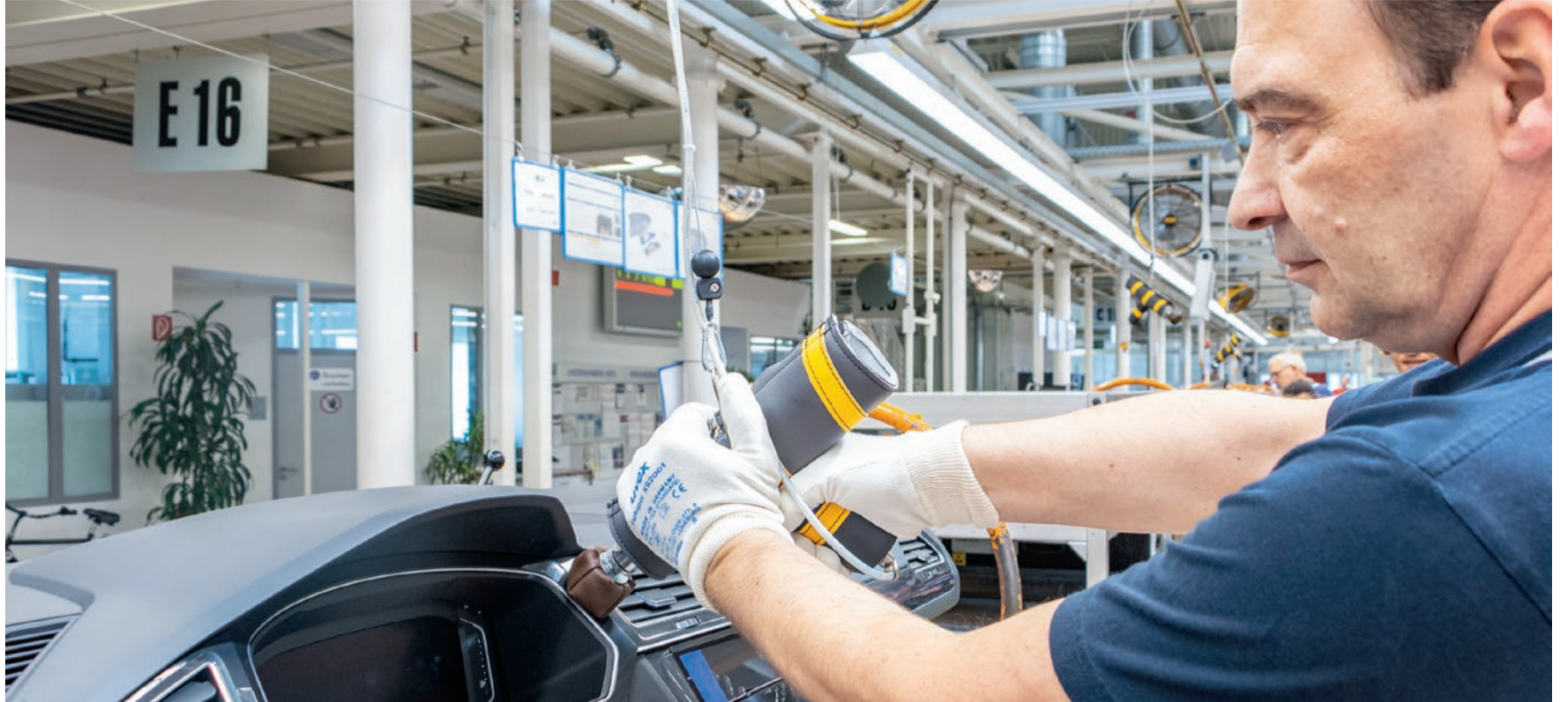
Druckluft ersetzt Fingerkraft: Teamsprecher Christoph Kohn verbaut die Cockpitblenden eines Tiguan.
