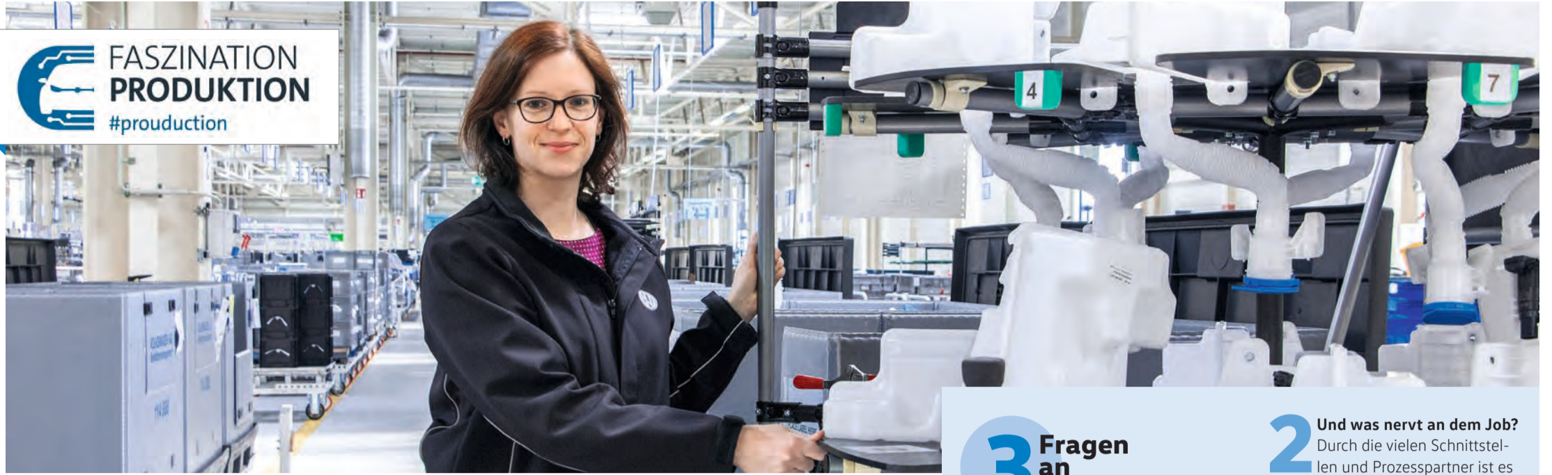
Als Logistikplanerin muss Sandra Swaczina Sequenzwagen für die Montage planen: Dieser Wagen für Wischwasserbehälter wird in Halle 55 bestückt und kommt in Halle 54 an die Montagelinie.
