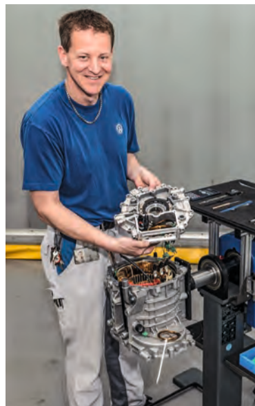
Moderne Technik: Tino Herwig statet den Prototyp eines Base-Elektroantriebs mit zusätzlichen Messsensoren aus.
