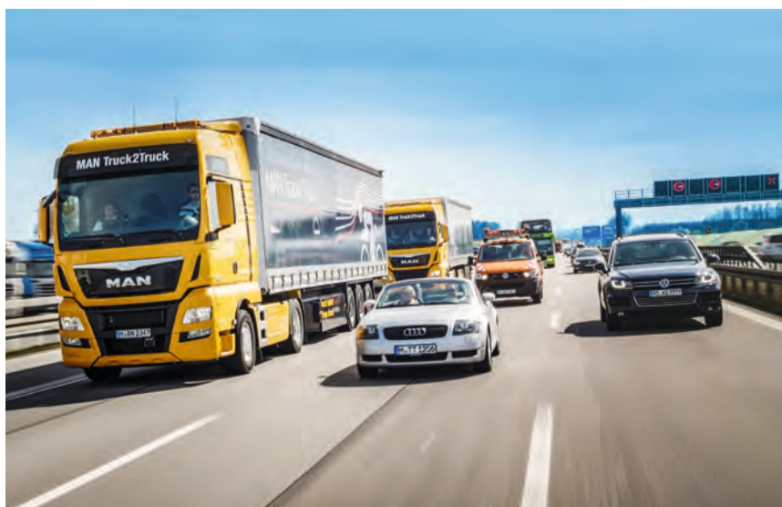
Testfahrt auf der A9: Zwei digital vernetzte Lkw erproben die Platooning-Technik. Der Fahrer vorn steuert dabei das zweite Fahrzeug mit. Der Fahrer hinten greift nur im Notfall ein.
