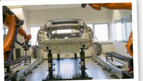
Doppelarm-Roboterzelle mit zu messendem Bauteil: Messzeit etwa 20 Minuten.
