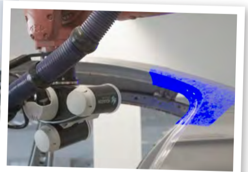
Messarm der Doppelarm-Roboterzelle: Belichtungszeit etwa 3 Millisekunden pro Bild (blaues Licht).
