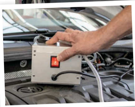
Neue Methode: Andreas Hummel (er ist nicht einer der Ideengeber) arbeitet in der Kundendienstwerkstatt im Werk Wolfsburg mit der elektrischen Unterdruckpumpe.
