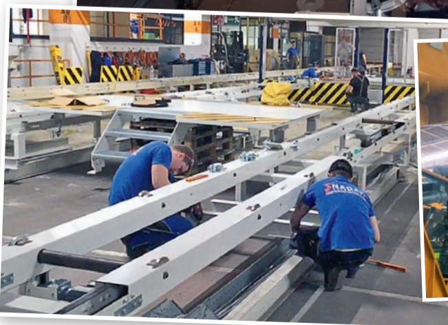
In der Lackiererei: Die Fördertechnik wurde umgebaut.
