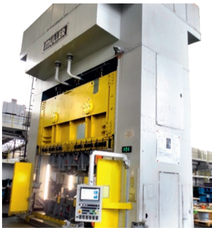
Im Presswerkzeugbau: die modernisierte Ziehpresse.
