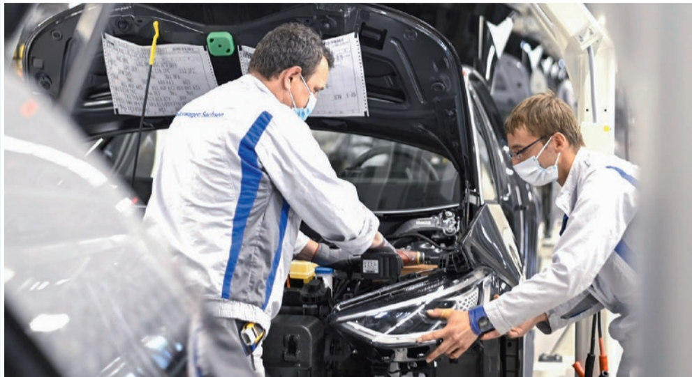
Produktion des ID.3 1 : Zwei Mitarbeiter bei Volkswagen in Zwickau verbauen gerade den Scheinwerfer. Beim reibungslosen Anlauf kommt es auf jedes Detail an.
