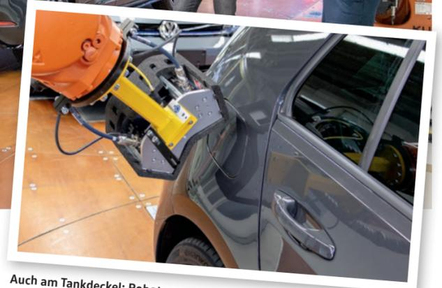
Auch am Tankdeckel: Roboter messen die Spaltmaße und Bündigkeiten mithilfe von Sensoren.
