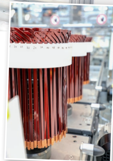
Die bronzenfarbenen Hairpins werden in einem speziellen Verfahren verschweißt.
