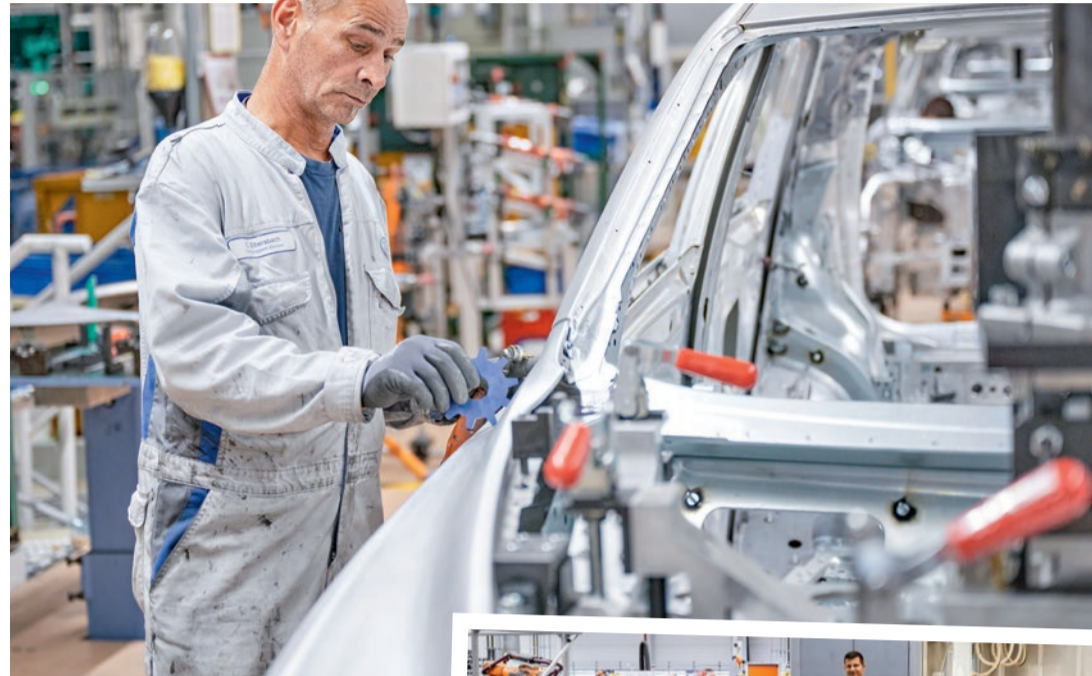
In der Montage-Anbauteile-Linie: Carsten Ebersbach bei der Spaltmaßprüfung an der Karosserie.
