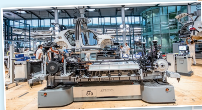
Kurz vor der Hochzeit: das Fahrwerk des ID.3, dahinter die Karosserie.
