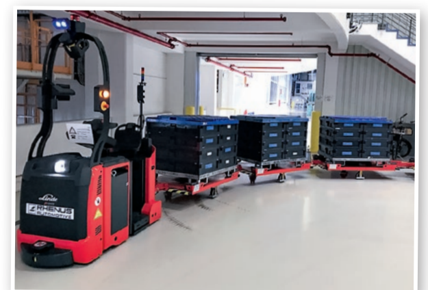
Fahrerloses Transportsystem: transportiert Material völlig autonom.
