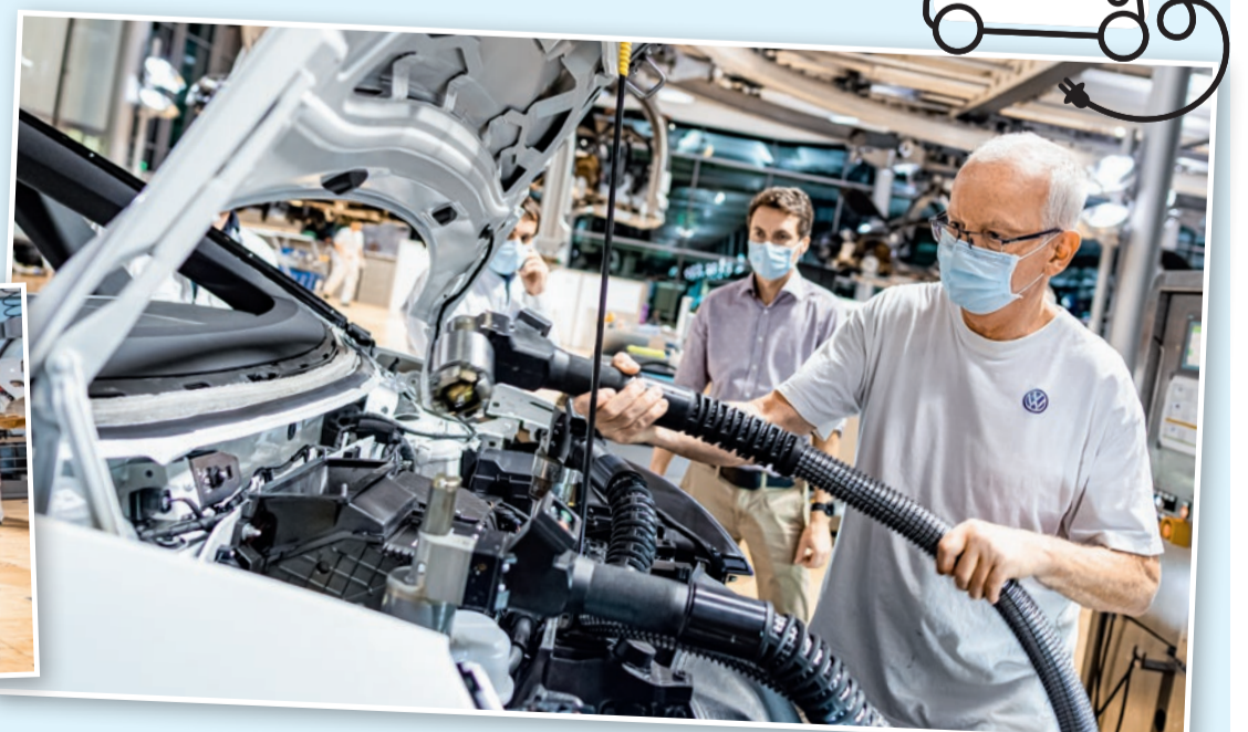
Kurz vor der Hochzeit: das Fahrwerk des ID.3, dahinter die Karosserie.
