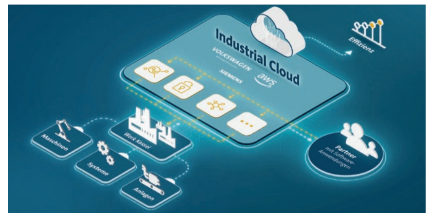
Transparente Fertigung: Die Industrial Cloud vernetzt standortübergreifend jede Maschine und jedes System mit den darauf gefertigten Bauteilen.
