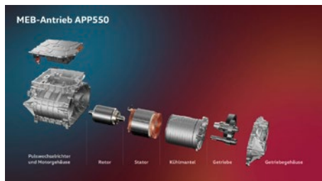
Die Komponenten des neuen MEB-Antriebs APP550.
