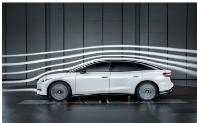
Der ID.7 bei Aerodynamiktests im Windkanal.
