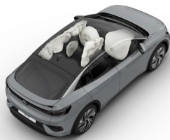
Das Airbag-System des ID.5 u.a. mit Kopf-, Center- und Seiten-Airbags.
