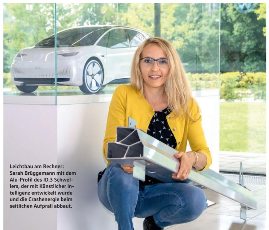
Leichtbau am Rechner: Sarah Brüggemann mit dem Alu-Profil des ID.3 Schwellers, der mit Künstlicher Intelligenz entwickelt wurde und die Crashenergie beim seitlichen Aufprall abbaut.
