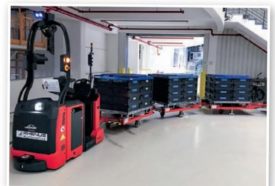
Fahrerloses Transportsystem: transportiert Material völlig autonom.
